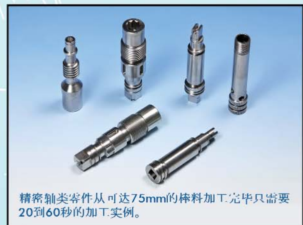
复杂零件从棒料到全面加工完毕只需要12秒的一些加工实例。
